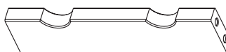
WINE RACK 414 X 63 X 20 • 264 X 63 X 20 ПЛАНКА ДЛЯ БУТЫЛОК 414 X 63 X 20 • 264 X 63 X 20 LISTELLI PORTABOTTIGLIE 414X63X20 * 264X63X20
